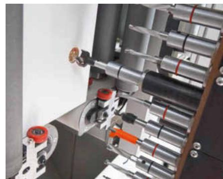
Das vertikal verfahrbare Bohrgetriebe mit einzeln steuerbaren Spindeln
