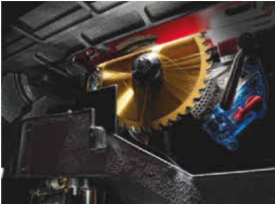
Herzstück der AIM-Technik ist eine Patrone, die einen Alublock mithilfe einer Feder ins Sägeblatt treibt
