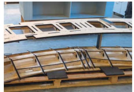
Unterbau des Tresens für ein Fernsehstudio in Dubai: Spantenbau mithilfe des Lasers
