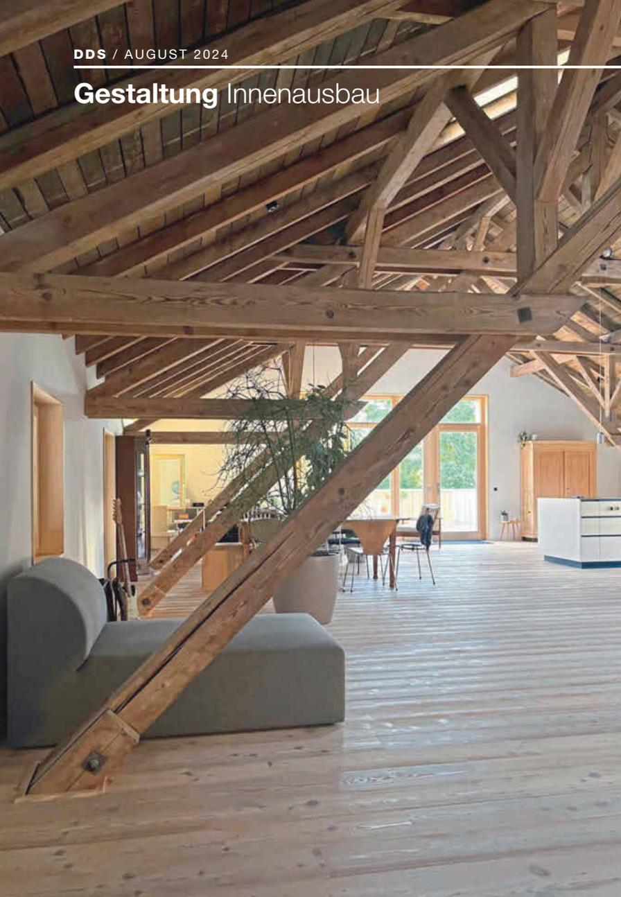
Der Dachstuhl des früheren Lagerraums prägt den Wohnraum. Er blieb sichtbar – darüber liegt nun eine Aufdachdämmung aus Holzwolledämmplatten
