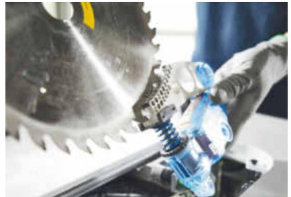
Ein Knall – und alles steht bei Hautkontakt. Mit wenigen Handgriffen sind Patrone und Sägeblatt gewechselt
