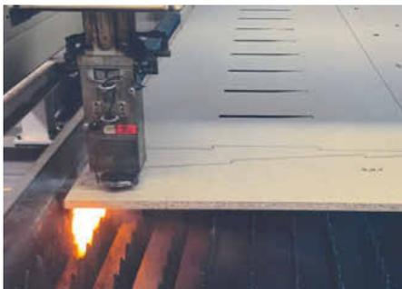
Der Laser erhitzt das Material und lässt es verdampfen. Es kommt zur Flammenbildung
