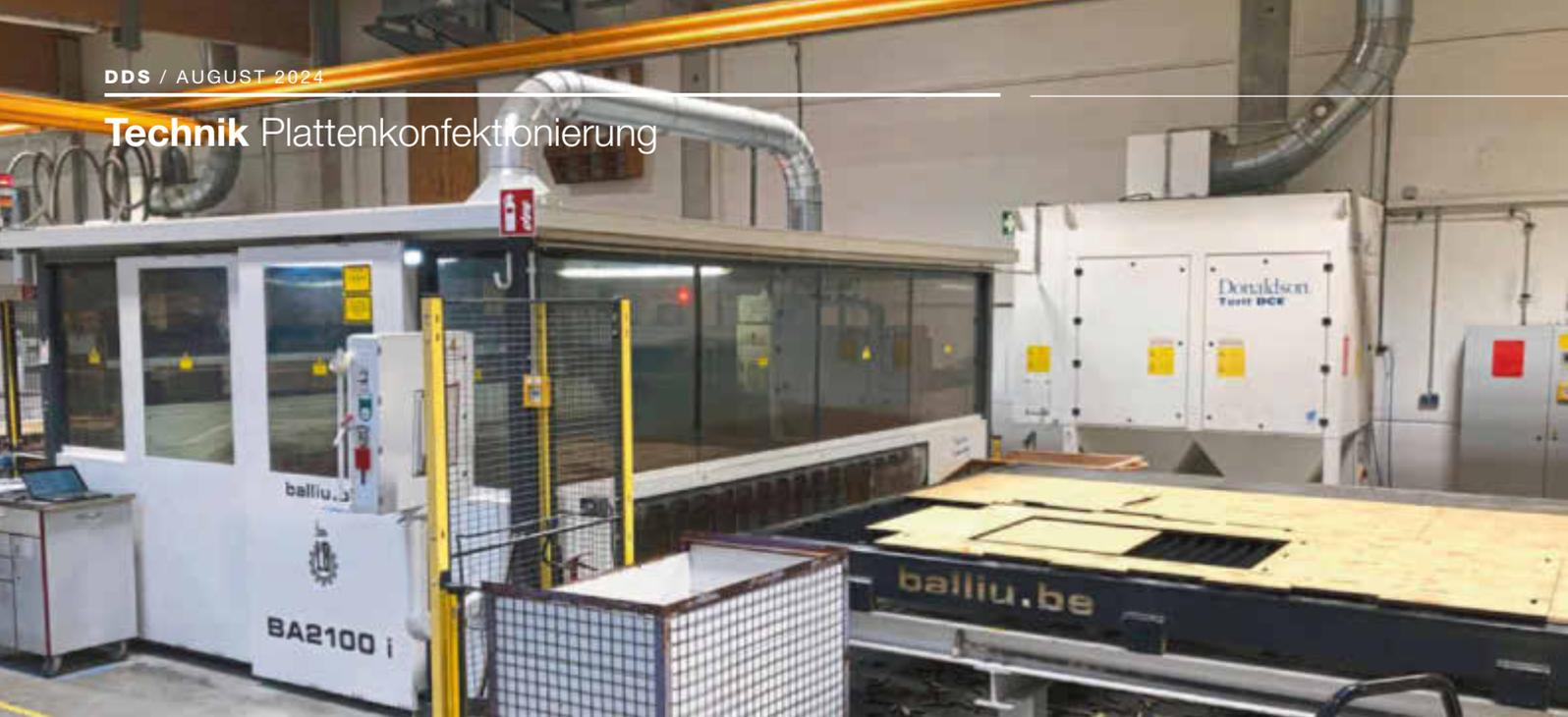
Der Laser kann Platten bis max. 42 mm Dicke teilen, auch abhängig von der Dichte des Materials
