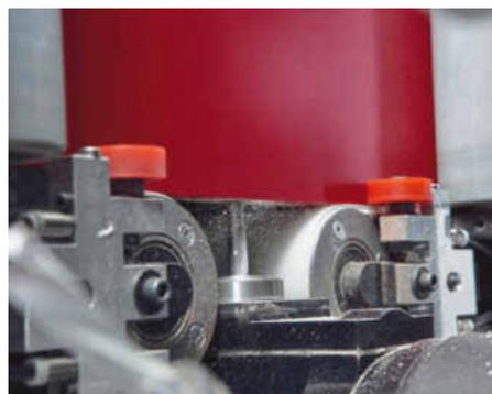
Bohren in die untere Schmalfläche durch die Lücke im Transportband
