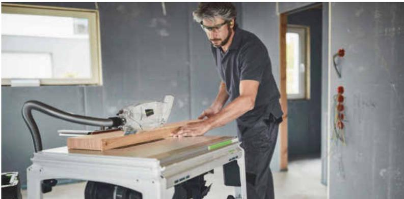
Mit der TKS 80 bietet Festool eine Tischkreissäge an, die mit der bewährten AIM-Technik von Sawstop vor schlimmen Arbeitsunfällen schützt
