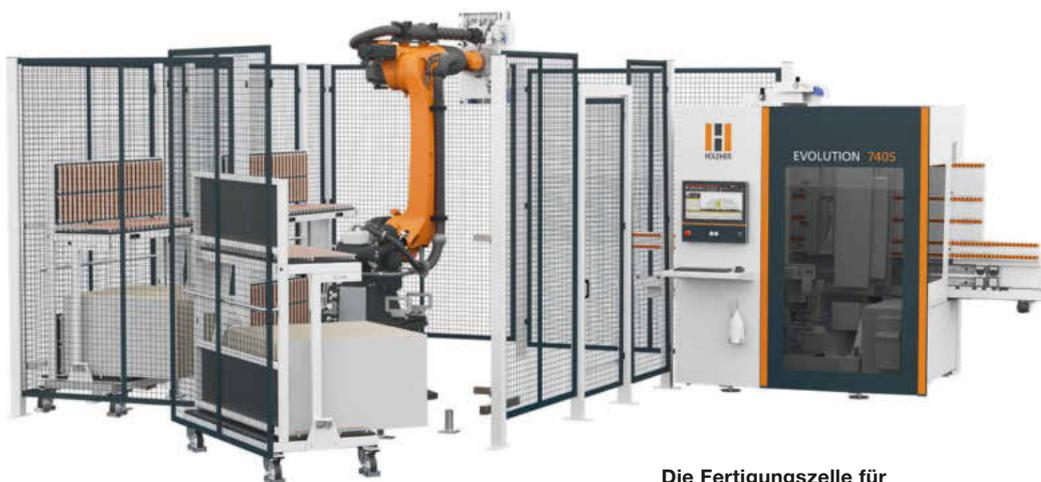
Die Fertigungszelle für Möbelteile besteht aus einer vertikalen CNC-Maschine und einem Roboter
